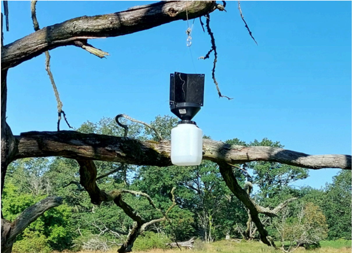
Feromonfällan består av en plastdunk, tratt och tvärställda plastskivor. I dunken finns en liten behållare betad med läderbaggens feromon. Foto Anders Jörneskog
